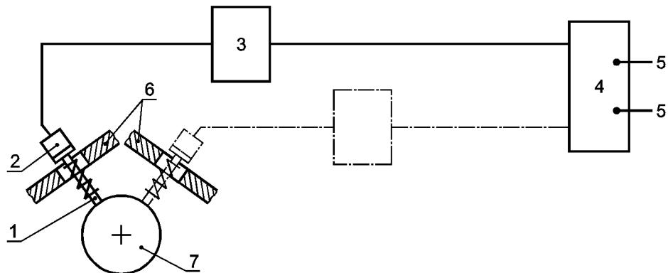
1 — датчик-зонд; 2 — датчик инерционного типа; 3 — устройство согласования; 4 —читывающее устройство; 5 — дополнительные выходы для систем анализа и контроля; 6 — элементы конструкции машины; 7 — вал
