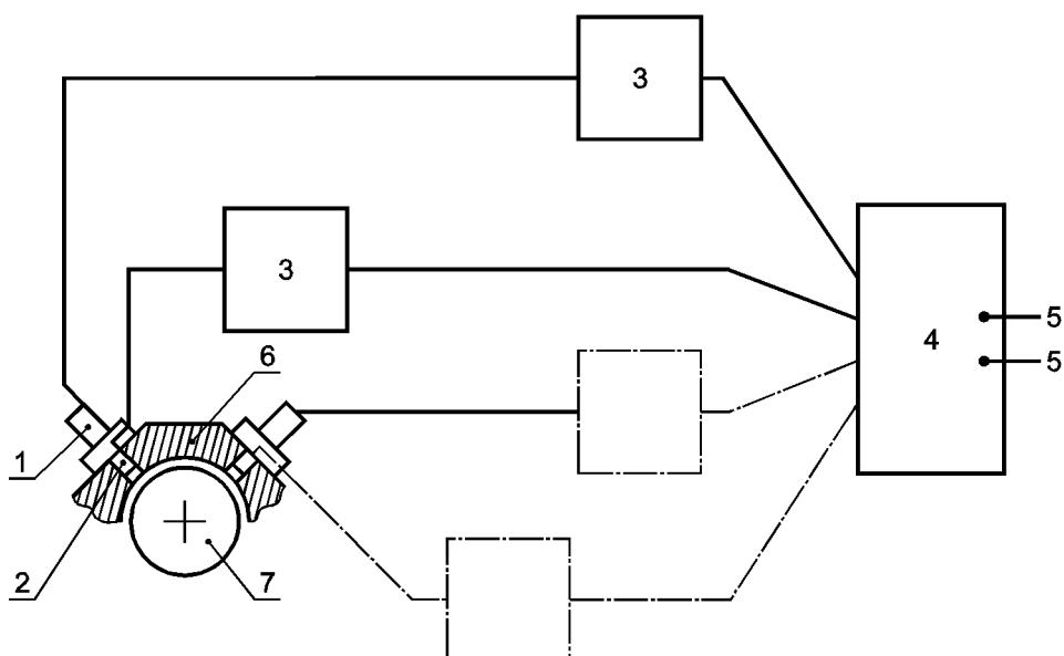
1 — датчик инерционного типа; 2 — датчик бесконтактного типа; 3 — устройство согласования; 4 —читывающее устройство; 5 — дополнительные выходы для систем анализа и контроля; 6 — элементы конструкции машины; 7 — вал
