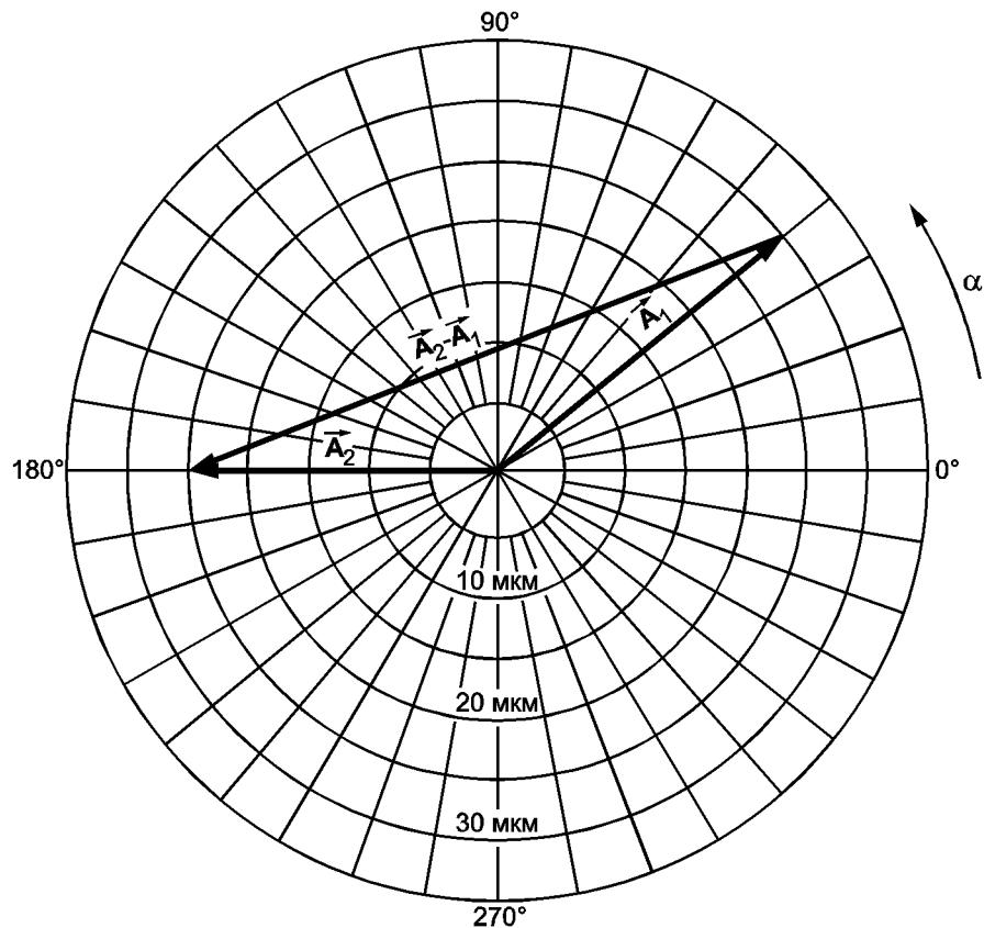
исходный вектор —  $|\vec{A}| = 30 \text{ мкм}$ ,  $\alpha = 40^\circ$ ; вектор после изменений —  $|\vec{A}_2| = 25 \text{ мкм}$ ,  $\alpha = 180^\circ$ ; изменение амплитуды вибрации —  $|\vec{A}_2| - |\vec{A}_1| = -5 \text{ мкм}$ ; амплитуда вектора изменения вибрации —  $|\vec{A}_2 - \vec{A}_1| = 52 \text{ мкм}$
