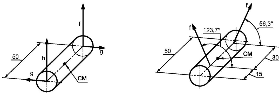
е) Разложение дисбалансов в торцовых плоскостях ротора на ортогональные составляющие
