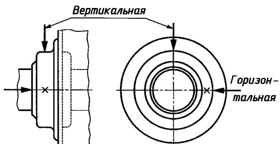
Рисунок 1б — Точки измерения на корпусе подшипника
