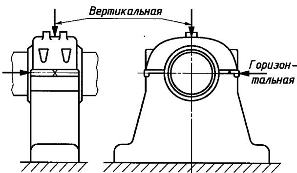
Рисунок 1а — Точки измерения на опоре подшипника
