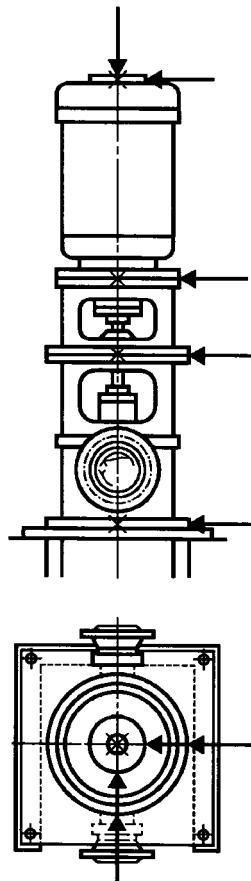
Рисунок 1д — Точки измерения на вертикально установленной машине
