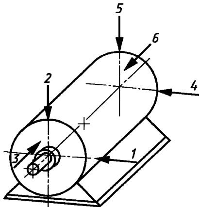
Рисунок 1в — Точки измерения на малых электрических машинах
