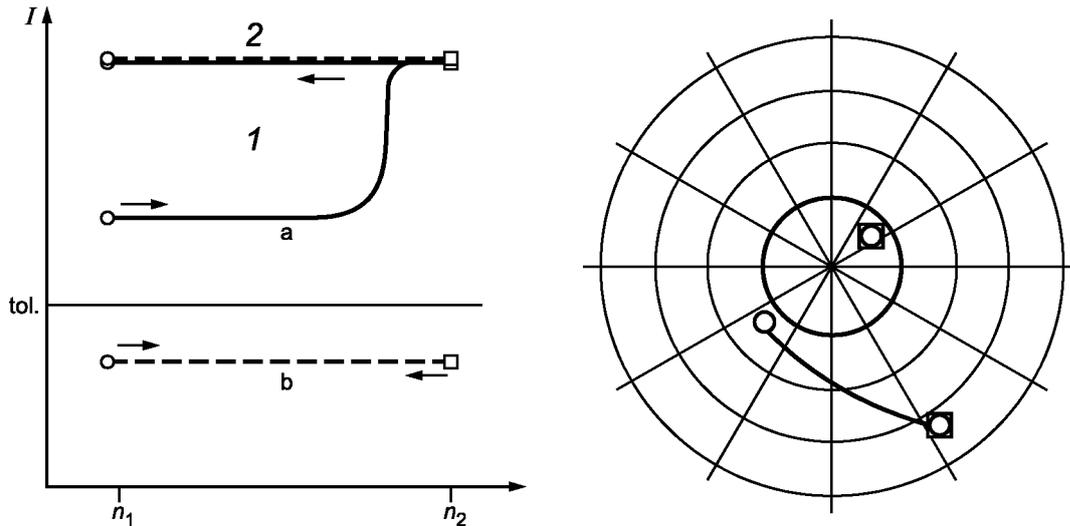
1 – первый пуск ротора; 2 – второй пуск ротора; а – неуравновешенный ротор; б – уравновешенный ротор;
