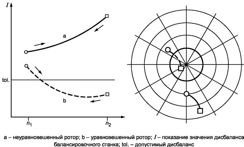
Примечание — На рисунке показано изменение дисбаланса для ротора с упругими элементами, который обладает свойствами жесткого ротора. Однако упругие элементы могут иметь и роторы других типов.
