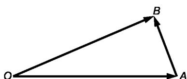
Рисунок G.1 — Векторный эффект установки пробных масс
